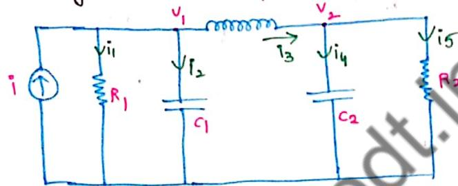
One input  $i(t)$ ;  $m=1$ . states-3  $i_3, V_1, V_2$
