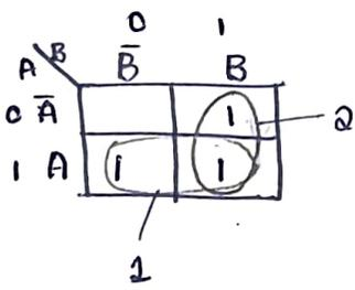
1<sup>st</sup> pair  $\left\{ \begin{matrix} A\bar{B} & \bar{A}B \\ AB & AB \end{matrix} \right\}$  2<sup>nd</sup> pair
